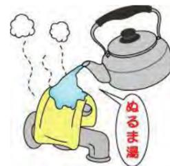
水道管の露出部分や蛇口に布やタオルをかぶせ、上からぬるま湯をゆっくりとかけて溶かしてください。水道メーターの計器以外に同様の処置をしても有効です。
