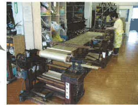
機巻き 経糸を張りながら柄を合わせ、巻きとる作業
